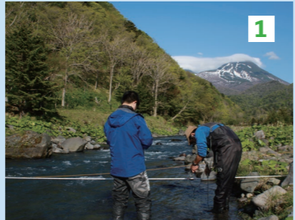
調査箇所の水深や流速を計測する
