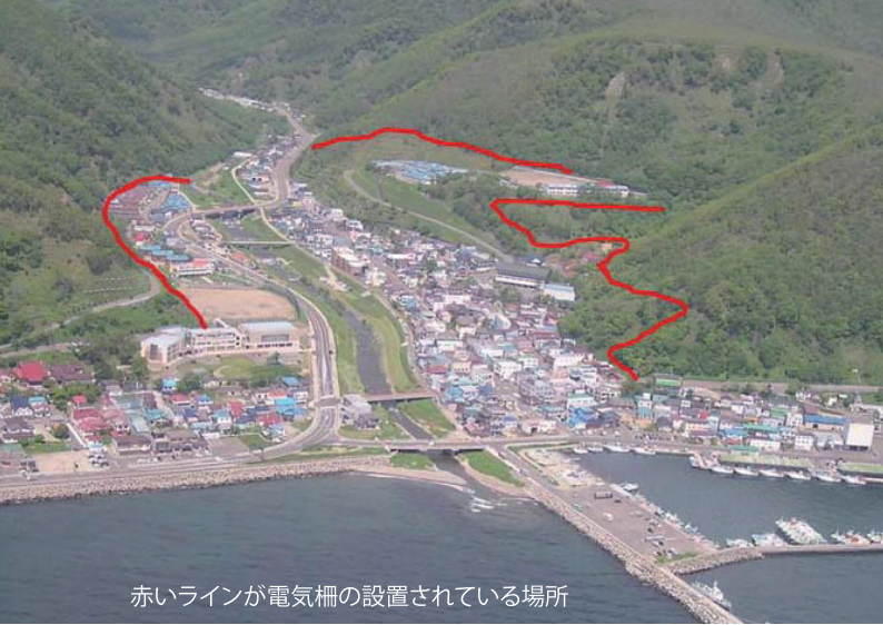
(左) 羅臼市街地中心部。学校や住宅を取り囲むように電気柵が設置されている (上) 先端部の北浜地区。海岸線の道路と山の境界線に沿って電気柵を設置している
