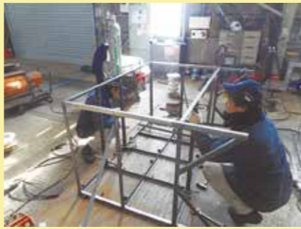
とれんベアの枠組み作業の様子。この後枠ごと亜鉛メッキを施す。通称、ドブづけ。
